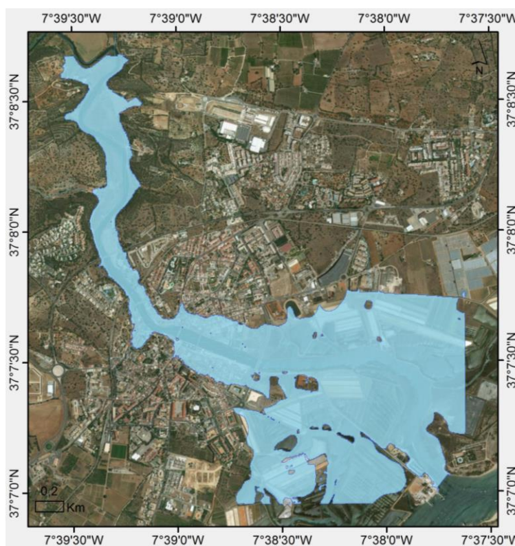
Figura 7. Zona Crítica de Tavira – área inundada para o período de retorno de 100 anos
