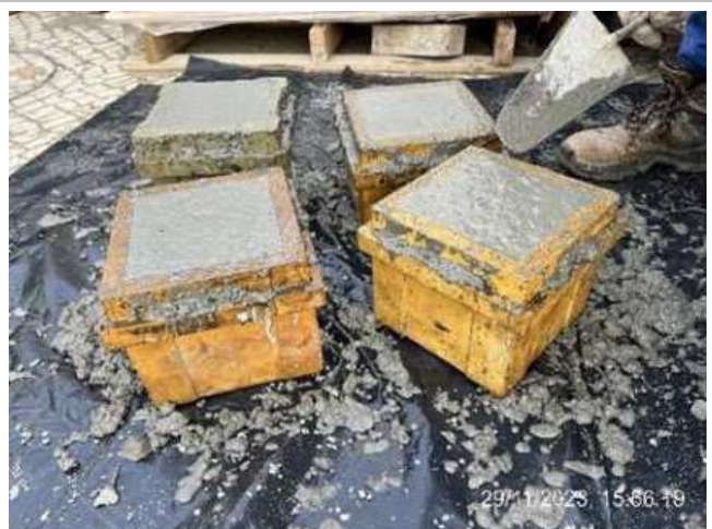
Frente de obra da plataforma Superior do Ascensor – 4 Provetes para ensaio à compressão 29/11/2023 – GR P518/0083484;
