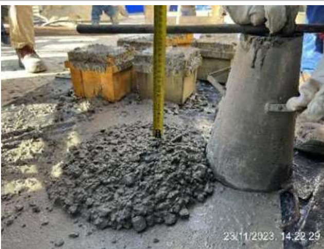
Frente de obra da plataforma Superior do Ascensor – 4 Provetes para ensaio à compressão 23/11/2023 - GR P518/0083326;
