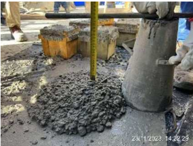
Frente de obra da plataforma Superior do Ascensor – Ensaio de Slump 23/11/2023 - GR P518/0083326;
