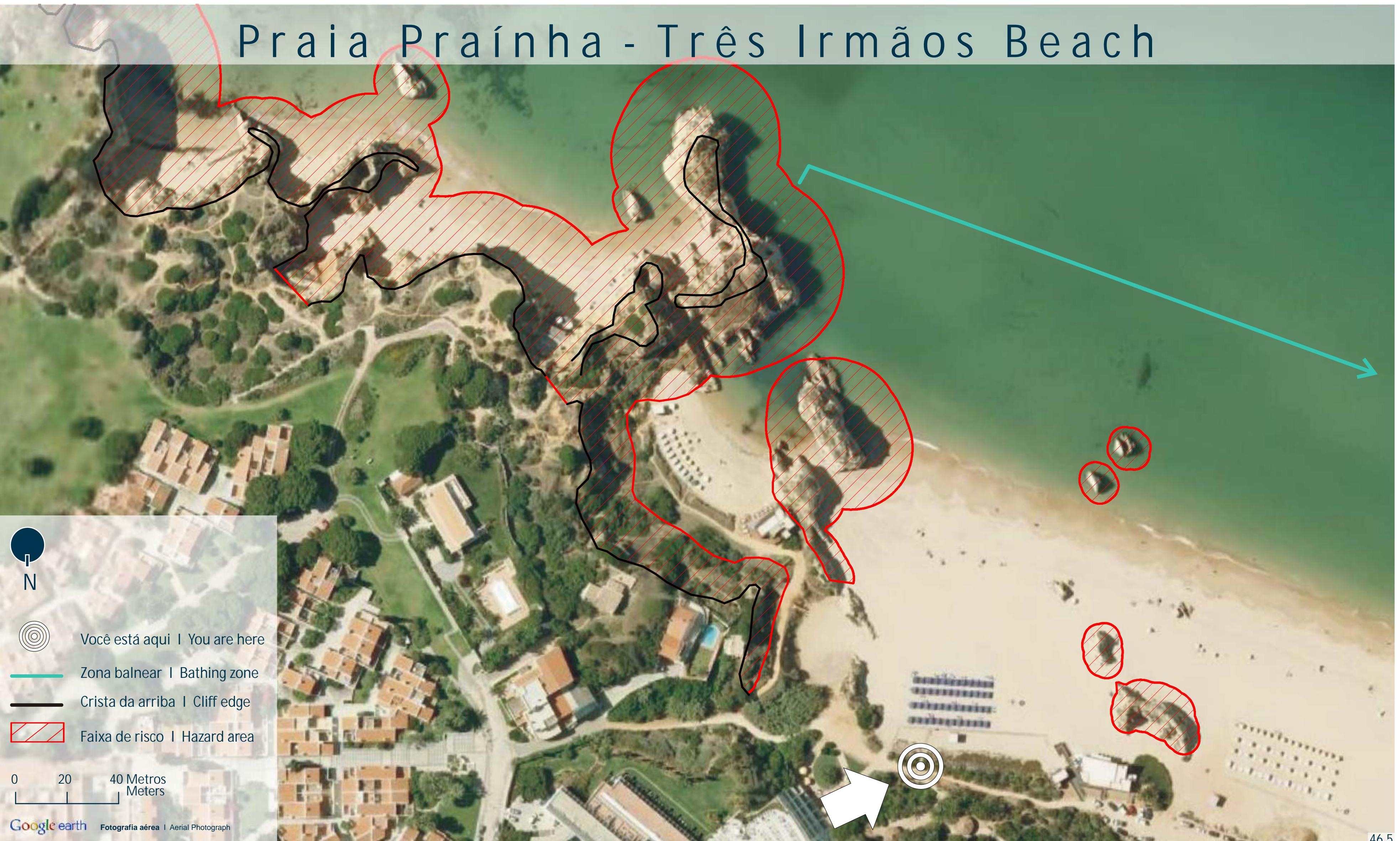
A evolução (erosão) natural das arribas processa-se numa sequência intermitente e descontínua de derrocadas instantâneas, dinâmica que constitui perigo para os utentes das praias. A FAIXA DE RISCO corresponde à área passível de ser ocupada pelos resíduos de desmoronamentos e tem largura igual a 1.5 vezes a altura da arriba. Para sua segurança permaneça afastado do topo e da base das arribas, bem como de penedos (leixões) isolados.
