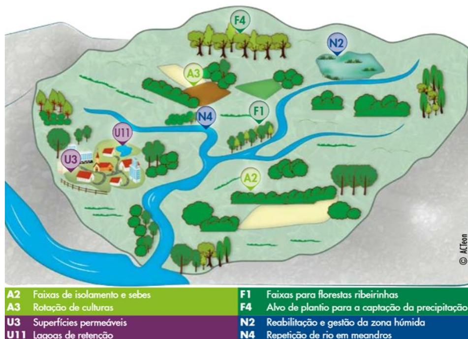
**Figura 34 - Representação esquemática de uma bacia hidrográfica e implementação de medidas verdes (adaptado de NWRM, 2013).**
