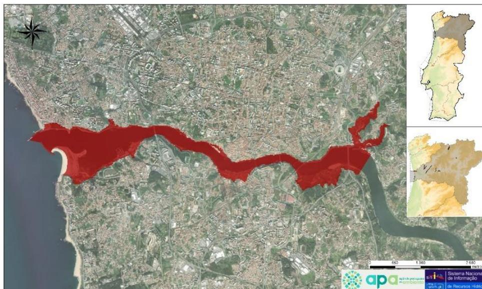
*Figura 25 - Área inundada para o período de retorno de 100 anos, ARPSI do Porto-Vila Nova de Gaia (PTRH3Douro01)*
