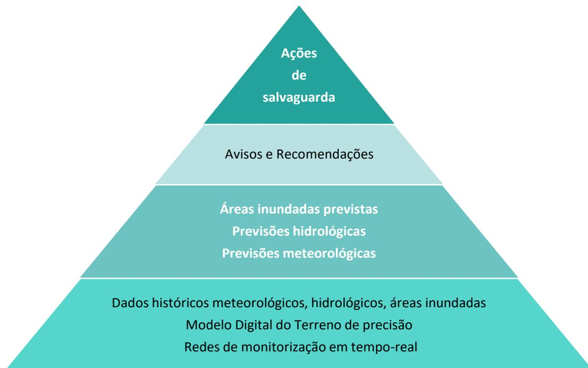
*Figura 33 - Componentes de um Sistema de alerta e previsão (WMO, 2018)*
