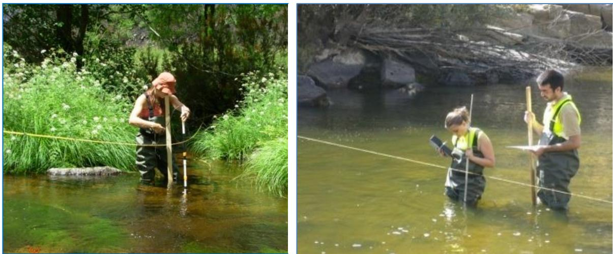
**Figura 3.31 - Procedimento de medição de caudal**
