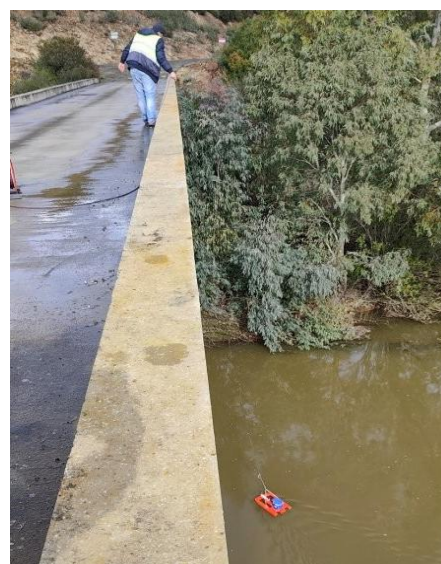
Figura 16 -Medição do Caudal em Oeiras com equipamento ADCP a partir da ponte (SNIRH, 2025).
