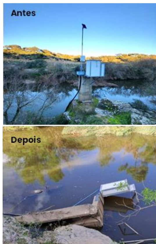
Figura 30 – Estação hidrométrica de Vendinha antes e depois da cheia
