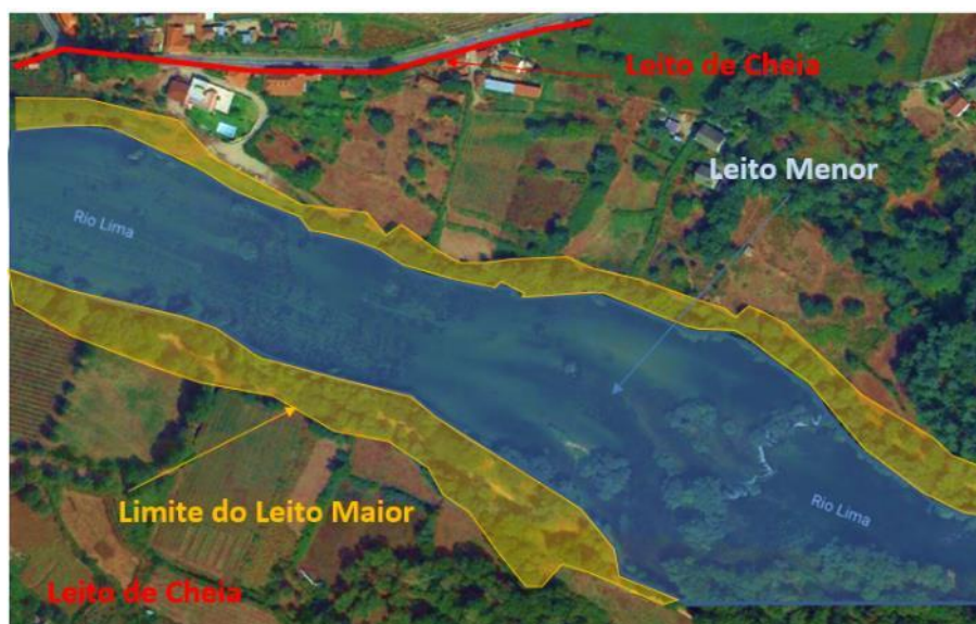
Figura 3.18 - Representação em planta da conectividade ecológica transversal
