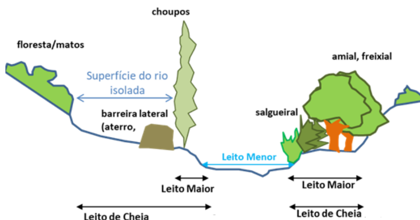
Figura 3.29 - Representação esquemática da limitação da conectividade transversal por estruturas artificiais
