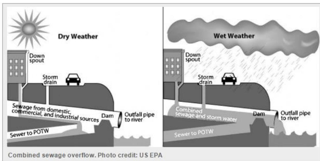
**Figura 8.35 - Solução esquemática que exemplifica o aproveitamento do sistema de saneamento para encaminhamento das águas em situação de grande pluviosidade.**
