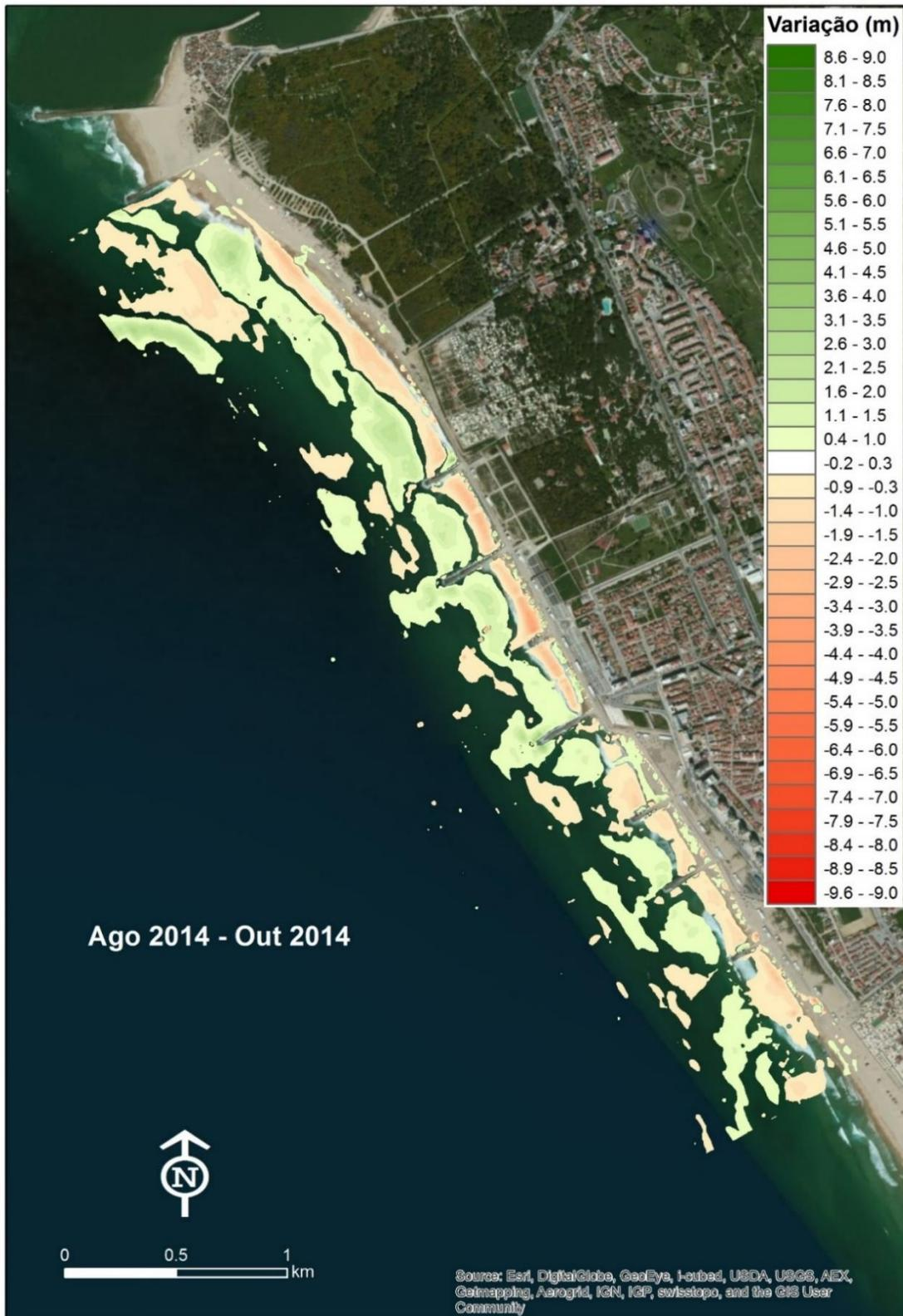
**Figura 4** – Diferença de cotas e variabilidade morfológica entre levantamentos consecutivos (FCUL/APA, 2014) na “célula de monitorização” (Nota: nos locais onde se verificaram variações altimétricas inferiores a 30cm as mesmas não estão representadas (sem cor)).
