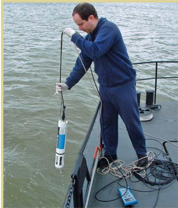
**FIGURA 11** - Utilização de uma sonda multiparâmetro
