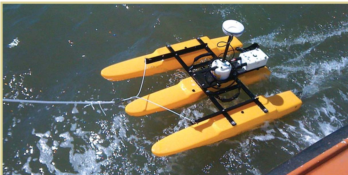
**FIGURA 9** - Correntómetro (SNTEK) em testes de utilização
