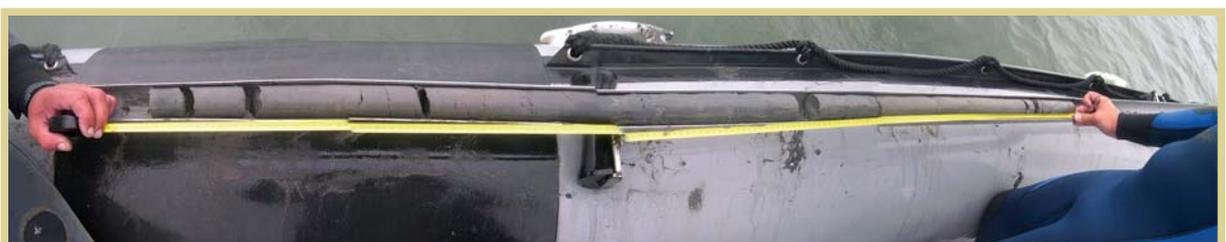
**FIGURA 3** - Exemplo de testemunho de sondagem realizado em 2007 no Estuário do Tejo para caracterização dos sedimentos e do respectivo grau de contaminação
