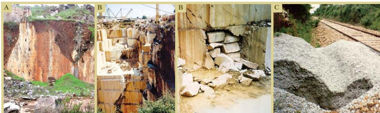
FIGURA 2 - A - Espessura irregular de solo de alteração; B - Exemplos de dissolução do mármore devido à circulação subterrânea; C - Circulação subterrânea activa
