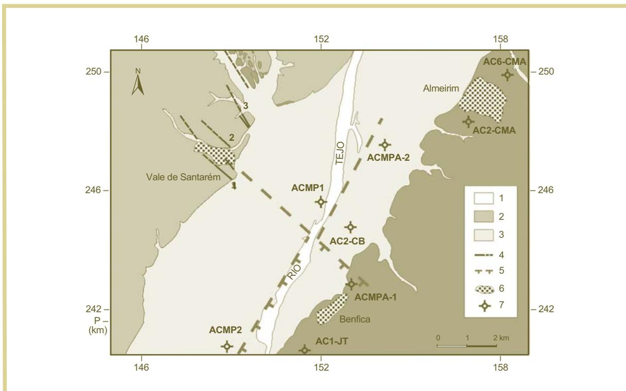
**FIGURA 2** - Modelo proposto para falhas inferidas por critérios geofísicos e/ou hidrogeológicos, a partir do estudo de furos de pesquisa de água subterrânea. Cartografia geológica adaptada. 1, aluviões fluviais holocénicas; 2, sedimentos plistocénicos e cobertura arenosa indiferenciada; 3, sedimentos pliocénicos e miocénicos; 4, falha (certa e provável); 5, falha oculta inferida (denteado no bloco deprimido); 6, povoação; 7, furo. (Mendonça e Cabral, 2003)
