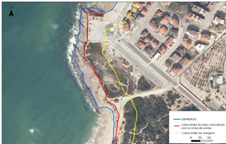
Fig.8 – Demarcação da LMPAVE, da linha limite do leito coincidente com a escarpa de erosão e linha limite da margem, Promontório a sul da Praia do Pedrogão – Leiria. IGO 2011
