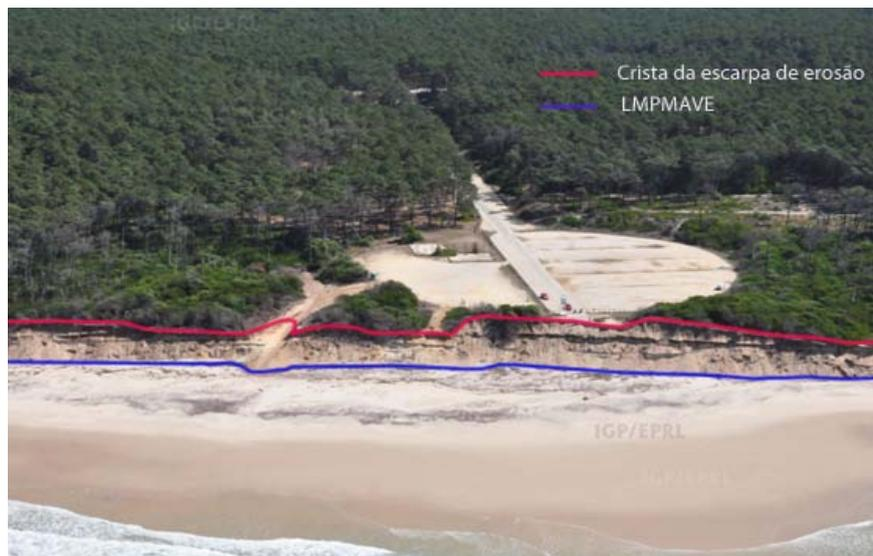
Fig. 2 – Perspetiva aérea oblíqua com representação da LPMAVE e da crista da escarpa de erosão na Praia de São Pedro da Maceda - Ovar. IGP/EPRL 2010.
