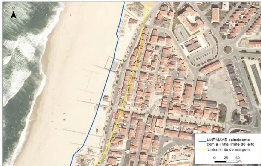
Fig.10 – Demarcação da LMPAVE e da linha limite da margem, na Praia da Tocha – Cantanhede. IGO 2011
