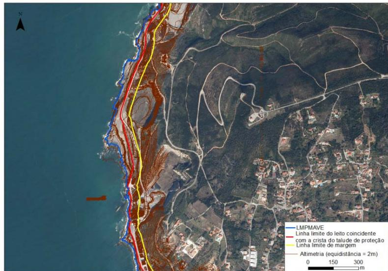
Fig.29 –Demarcação da linha limite do leito e da margem das águas do mar sobre os ortofotomapas do IGP com recurso às linhas isométricas dos levantamentos aerofotogramétricos DO ex-INAG. INAG (2001); IGP (2011).
