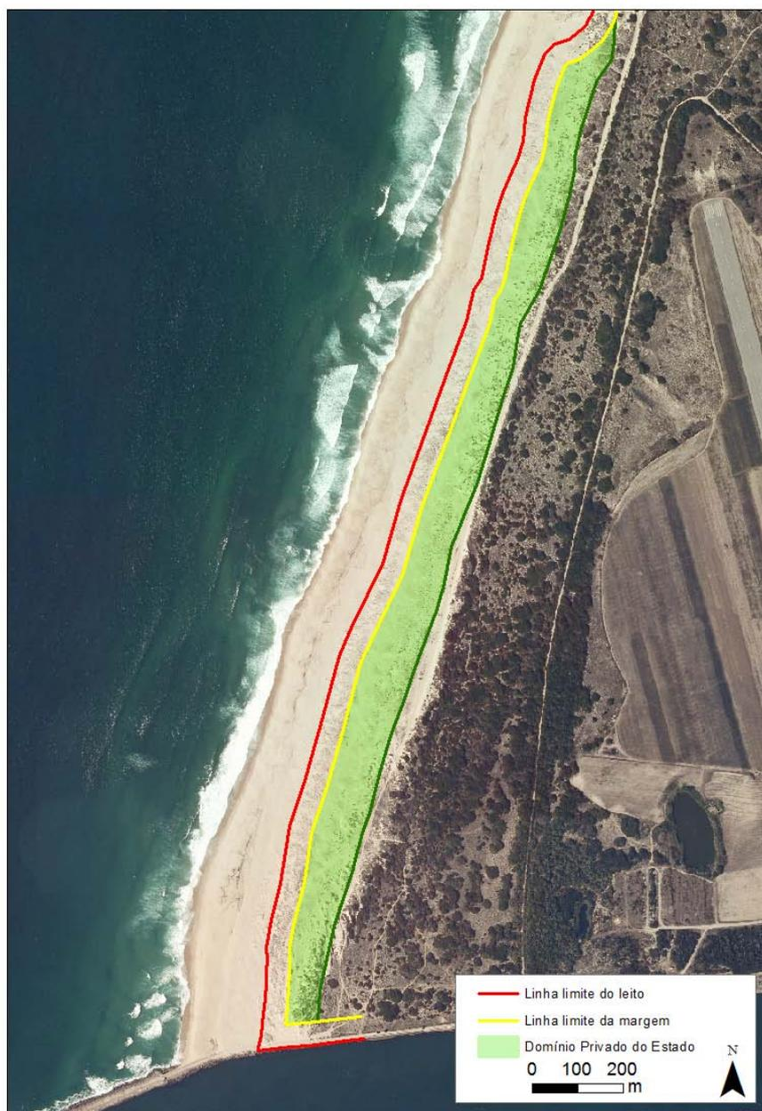
Fig.22 – Demarcação da linha limite do leito, da margem, e da área do domínio privado do Estado na Praia de S. Jacinto – Aveiro. IGO 2011
