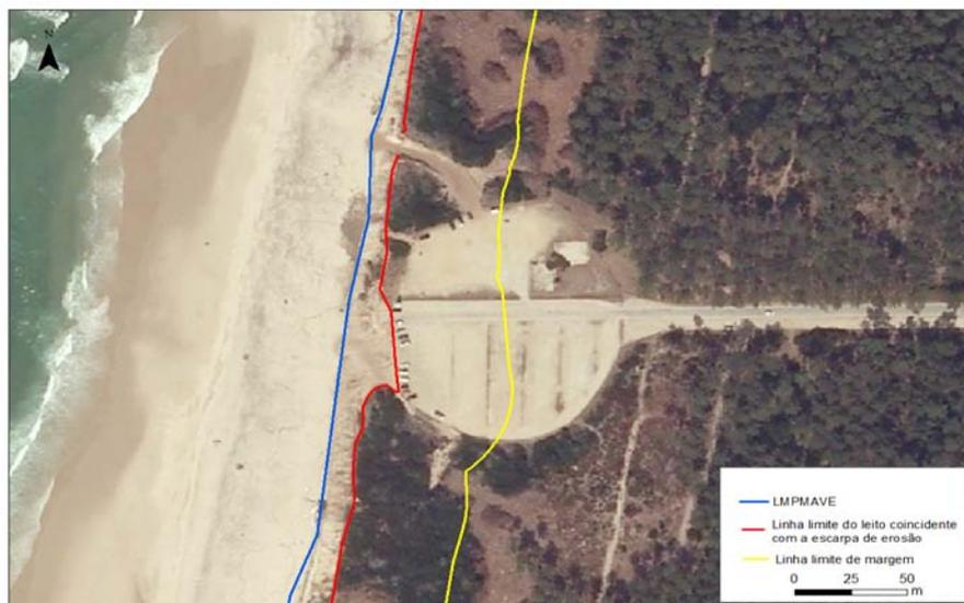
Fig.3 – Demarcação da LMPAVE e da linha limite do leito, pela base e crista da escarpa de erosão respetivamente e demarcação da linha limite da margem. IGO 2011
