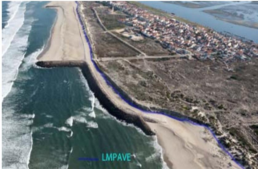
Fig. 14 – Perspetiva aérea oblíqua com representação da LMPAVE em situação de galgamento da defesa de proteção, a sul da Praia de Costa Nova - Ílhavo. Foto Porto de Aveiro S.A
