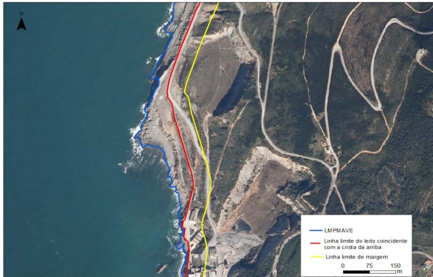
Fig.7 – Demarcação da LMPAVE, da linha limite do leito coincidente com a escarpa de erosão e linha limite da margem no Cabo Mondego – Figueira da Foz. IGO 2011
