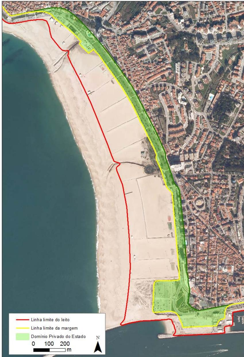
Fig.28 – Demarcação da linha limite do leito, da margem, e da área do domínio privado do Estado nas Praias da Figueira da Foz e Buarcos, Figueira da Foz. IGO 2011
