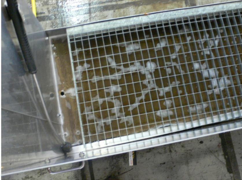
*Figura 5 - Mecanismo de lavagem de pneus com reciclagem de água*
