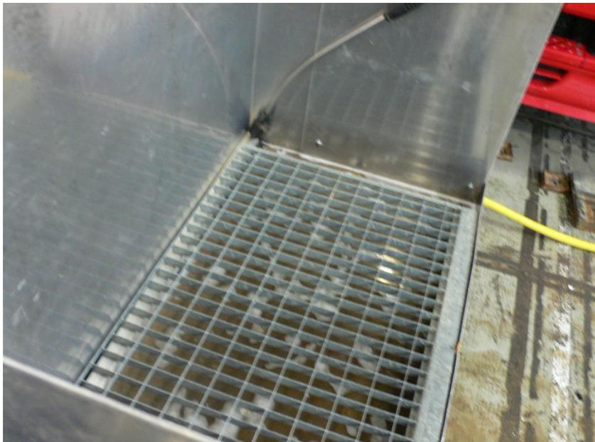
*Figura 6 - Mecanismo de lavagem de pneus com reciclagem de água*
