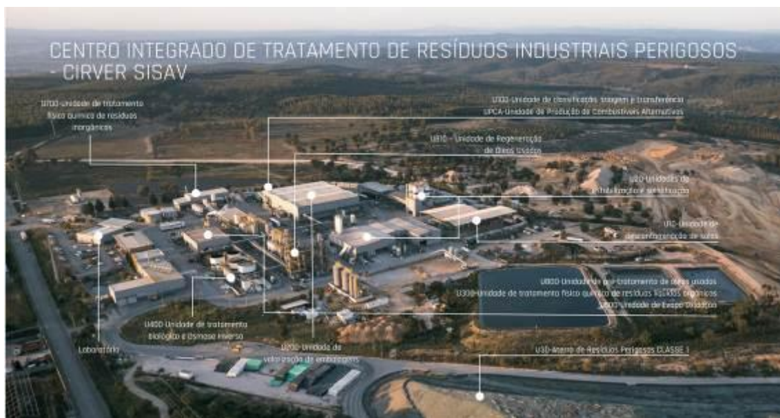
Figura 1 – CIRVER SISAV – Layout da instalação
