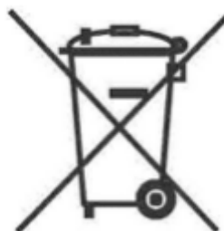
Figura 5 – Exemplo marcação de baterias, em conformidade com o Regulamento de Baterias
