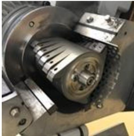
Figura 9. Moinho de corte utilizado na fragmentação dos elétrodos.
