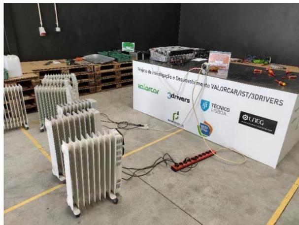
Figura 6: Descarga de módulos com resistências
