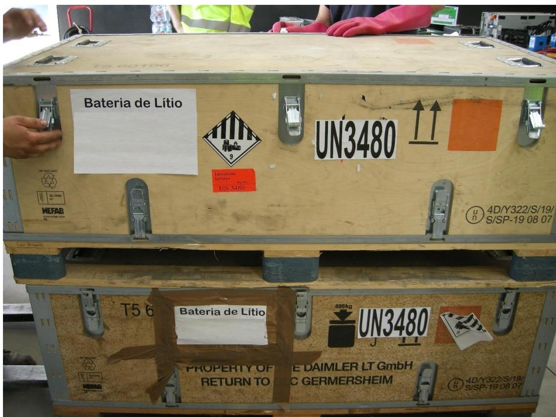
Figura 5: Caixas de armazenamento e transporte de baterias de lítio
