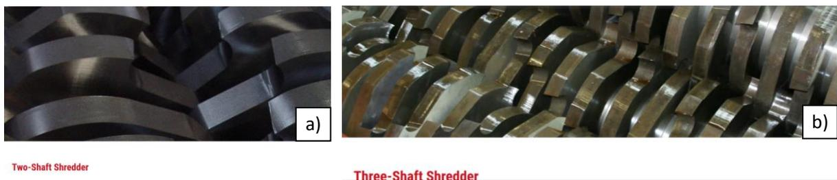
Figura 2. Fragmentadores Erdwich: a) de duplo eixo; b) de triplo eixo (imagens da ref [1]).
