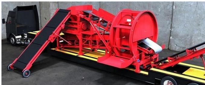
Figura 7. Fragmentador de baixo torque com facas especializadas (imagens da ref [3]).
