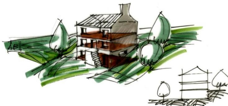
Figura 2.3 – Semicave completa (vista em perspetiva e corte)
