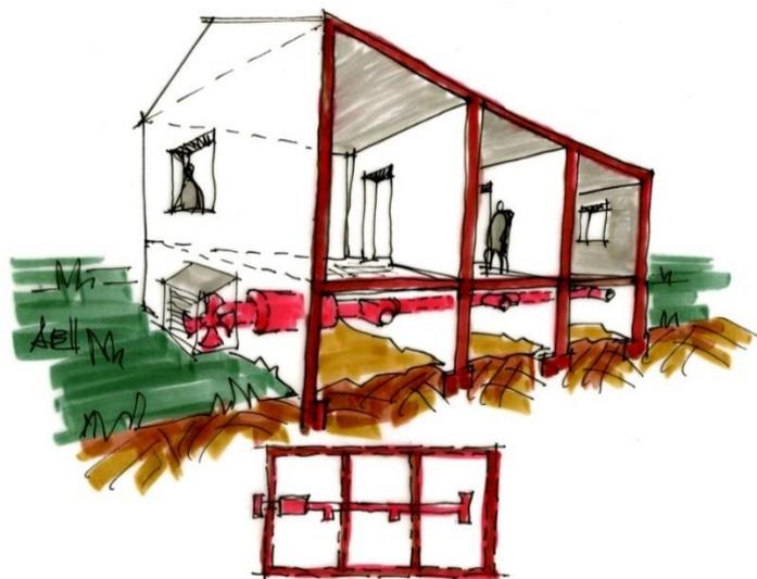
Figura All.3 – Representação de um sistema múltiplo de ventilação, equipado com um atenuador acústico, atuando por baixo de vários quartos
