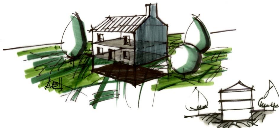
Figura 2.1 – Cave completa (vista em perspetiva e corte)
