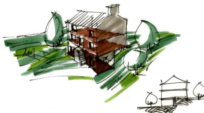
Figura 2.4 – Semicave parcial (vista em perspectiva e corte)
