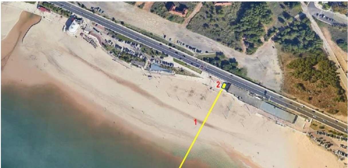
Figura 2 – Localização da amarração do cabo submarino na praia de Carcavelos (1 – traçado do cabo; 2 – Beach Manhole).
