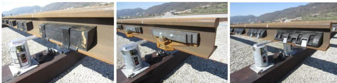
Figura 21. Atenuadores sintonizados de carril (TRD); esq. TATA/Corus, centro Schrey & Veit, direita STRAILastic\_A.
