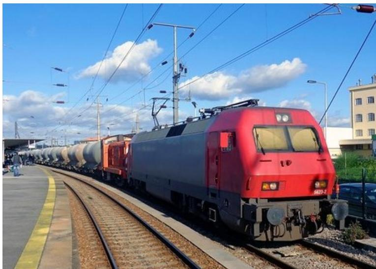
Figura 6. Comboio de mercadorias composto por locomotiva 5600 com vagões cisterna, na Linha do Minho.
