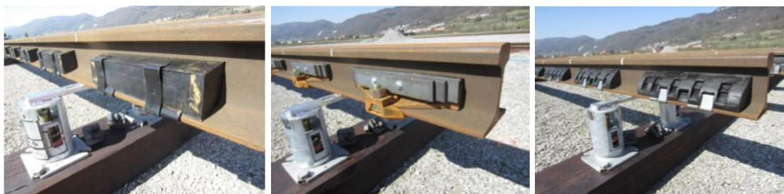
Figura 14. Atenuadores sintonizados de carril (TRD); esq. TATA/Corus, centro Schrey & Veit, direita STRAILastic\_A.
