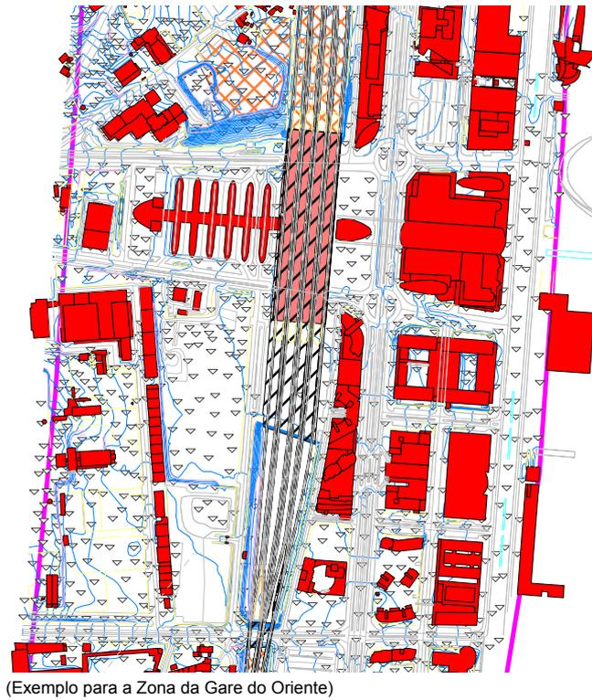
**Figura 40** Modelo 3D do terreno com vias-férreas ajustadas, edificado e barreiras acústicas implantadas
