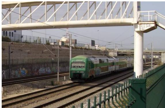
Cada UQE 3500 possui quatro unidades simples e um comprimento total de 106,6 m, o que resulta num comprimento prático por unidade simples de 26,7 m.
