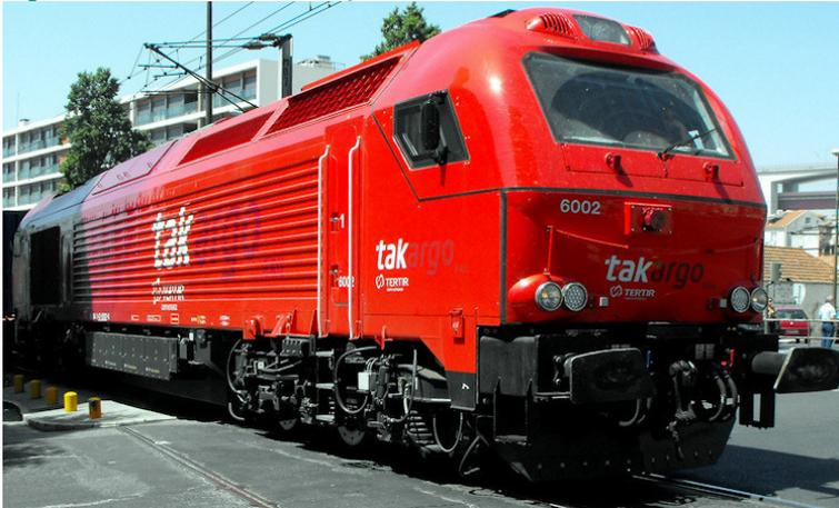
Figura 11 Locomotiva de tração *diesel-elétrica* da série 1400
