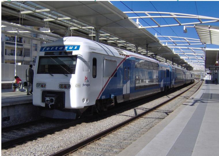
Cada UQE 3500 possui quatro unidades simples e um comprimento total de 106 m, o que resulta num comprimento prático por unidade simples de 26,7 m. As unidades UQE podem ser acopladas originando, assim, uma unidade múltipla UQE+UQE, com um comprimento total de 213,2 m. Estas unidades múltiplas são utilizadas pela FERTAGUS durante as horas de ponta.
