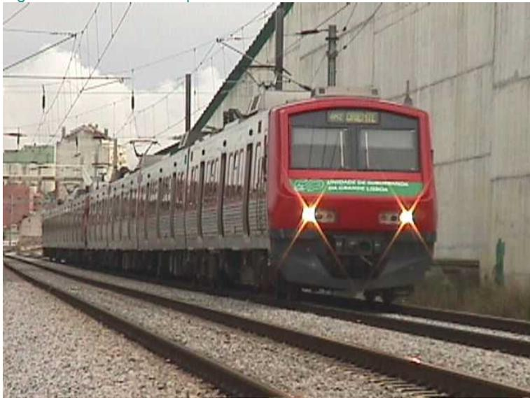
Cada UQE possui quatro carruagens e um comprimento total de 96 m. Assim, uma unidade múltipla UQE+UQE possui oito carruagens acopladas e um comprimento total de 192 m, o que resulta num comprimento por carruagem de 24 m. Algumas UQE 2300 foram alvo de uma reabilitação desde 2007. A fotografia da Figura 3 apresenta a UQE 2318 depois de reabilitada.
