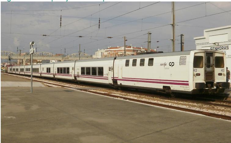
Os serviços regionais Entroncamento – Badajoz e Entroncamento – Marvão são efetuados por uma automotora da série 350. Trata-se de automotoras de tração *diesel*-elétrica em que o comprimento de cada automotora é de 23,6 m. A Figura 16 mostra uma automotora da série 350.
