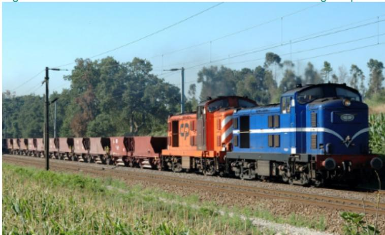
Figura 18 Locomotiva de tração *diesel-elétrica* da série 6000
