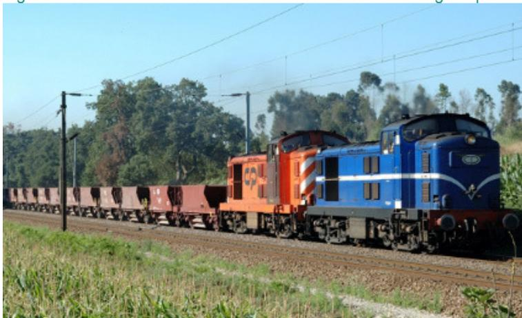
Figura 6 Locomotiva de tração *diesel-elétrica* da série 6000
