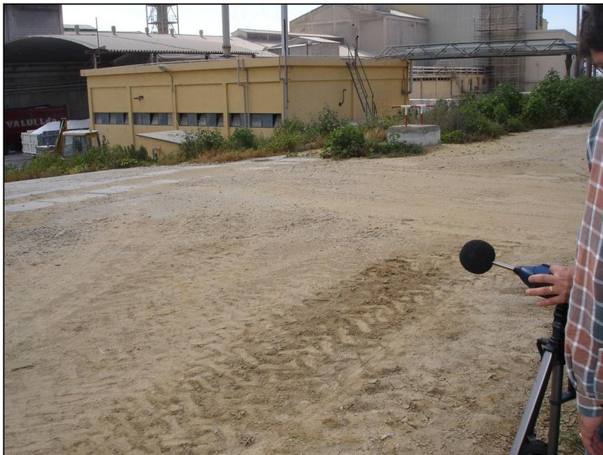
**Figura 2** Exemplo de uma medição com o sonómetro numa área industrial em estudo.
