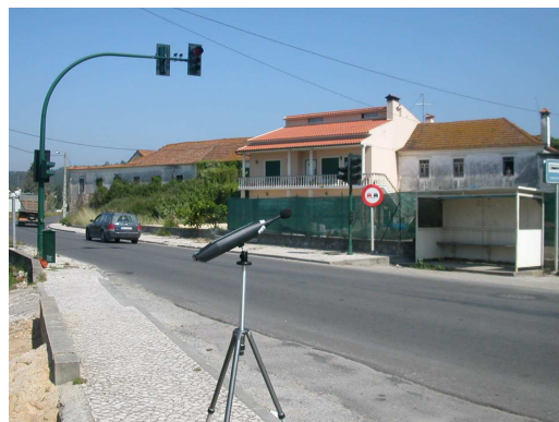
Figura 7 – Exemplo de monitorização do nível de pressão sonora junto a uma via rodoviária
