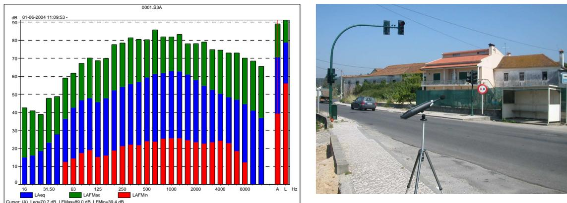
Figura 7 – Exemplo de monitorização do nível de pressão sonora junto a uma via rodoviária
