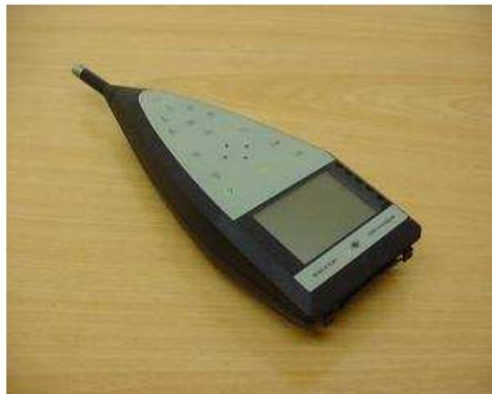
Figura 19 – Sonómetro de precisão integrador
