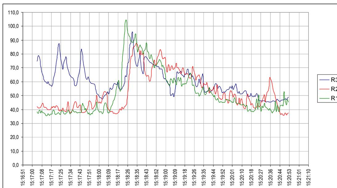
Figura 25 – Extracto para o intervalo de tempo de emergência, de medições em contínuo da pressão sonora (SPL) realizadas na envolvente da Base Aérea Militar
