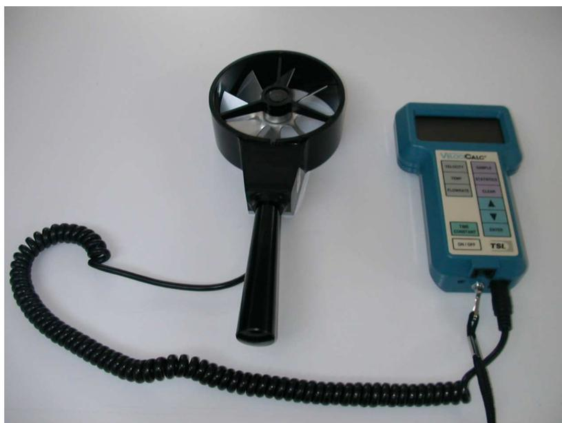
Figura 21 – Sensor de velocidade do ar tipo turbina.
