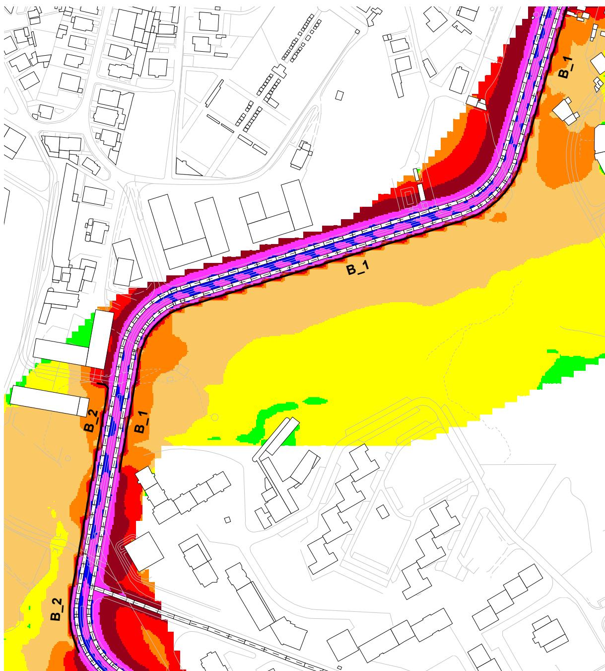
Figura 26 – Implantação da barreira B\_1 e da barreira B\_2; mapa de ruído resultante (1,5 m do solo)– indicador  $L_d$
