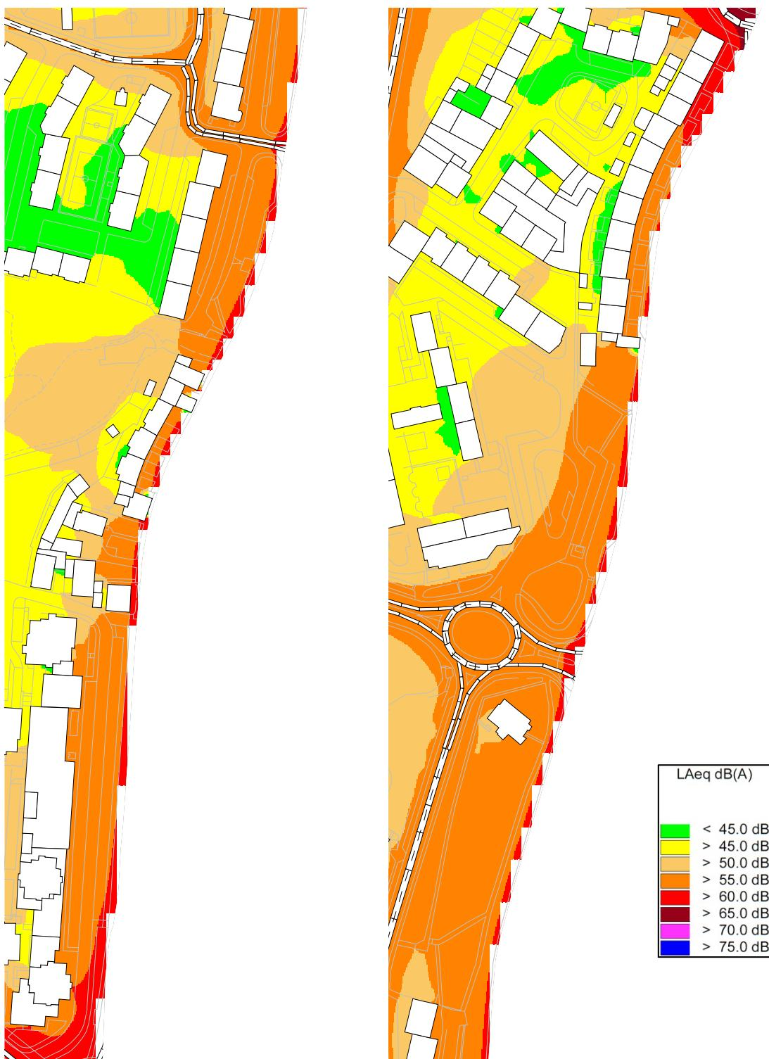
Figura 9 – Redução de velocidade; Esquerda: Av. Salgado Zenha a Rua N.º Sr.ª Nazaré; Direita: Rua N.º Sr.ª Nazaré a Rotunda do Almirante; Indicador  $L_n$
