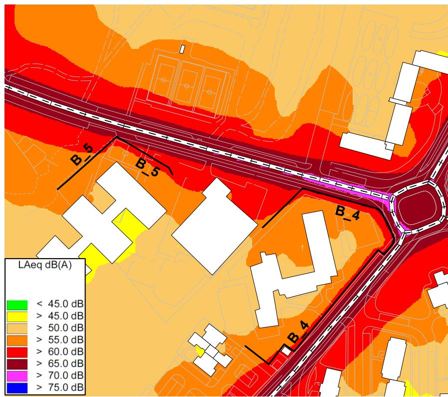
Figura 16 – Implantação das barreiras B\_4 e B\_5; Indicador  $L_{den}$
