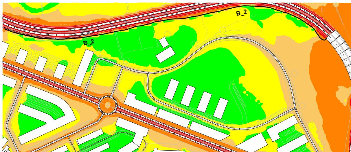
Figura 24 – Implantação da barreira B\_2; mapa de ruído global resultante (1,5 m do solo) – indicador  $L_n$
