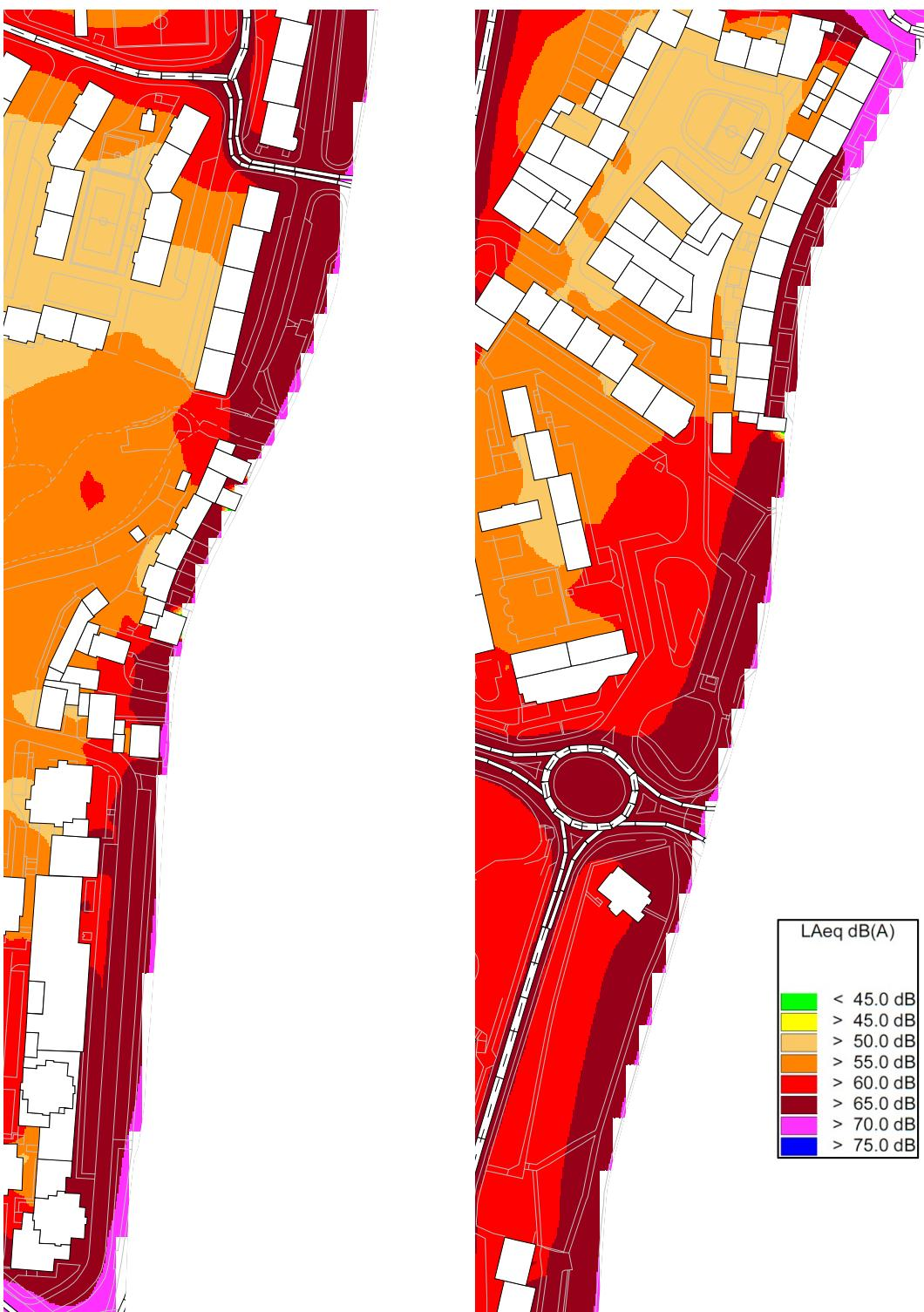
Figura 8 – Redução de velocidade; Esquerda: Av. Salgado Zenha a Rua N.º Sr.º Nazaré; Direita: Rua N.º Sr.º Nazaré a Rotunda do Almirante; Indicador  $L_{den}$
