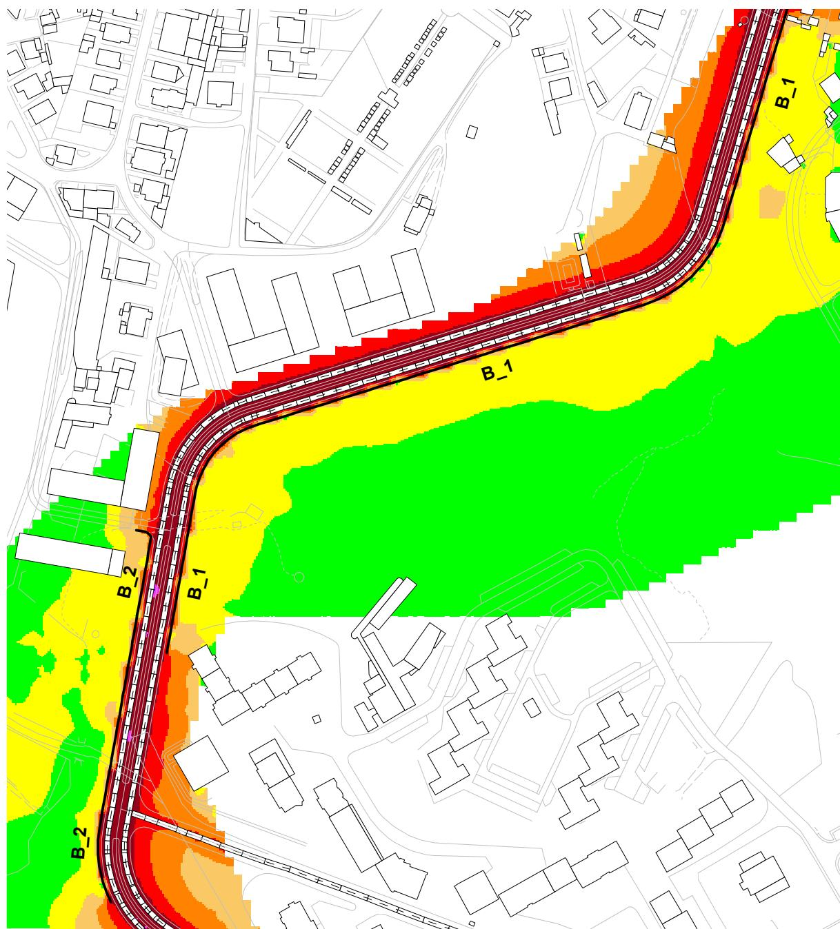
Figura 27 – Implantação da barreira B\_1 e da barreira B\_2; mapa de ruído resultante (1,5 m do solo)– indicador  $L_n$
