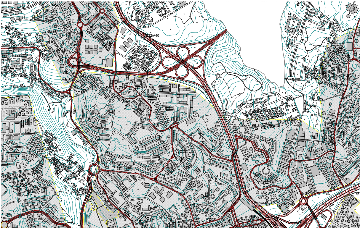
Figura 6. Dados de base do modelo acústico para o exemplo da zona da Figura 3, com curvas de nível, pontos cotados, edificado e implantação das vias de tráfego
