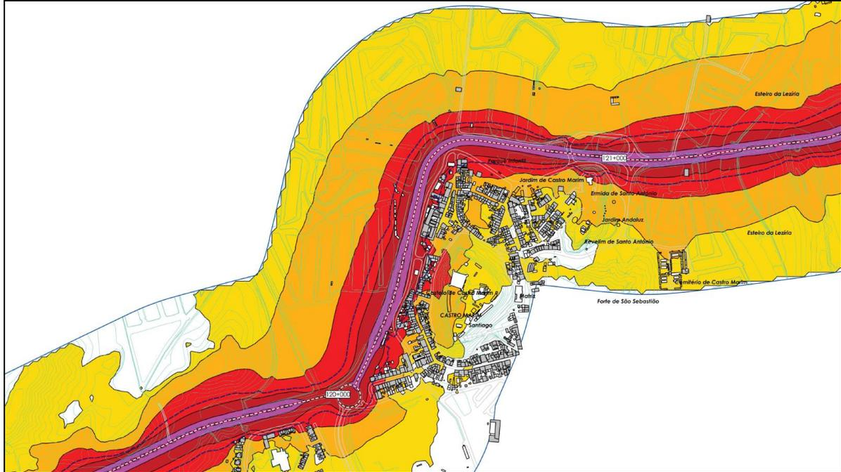
Figura 4-3 – Extrato do MER da EN122 para o indicador L<sub>den</sub>
