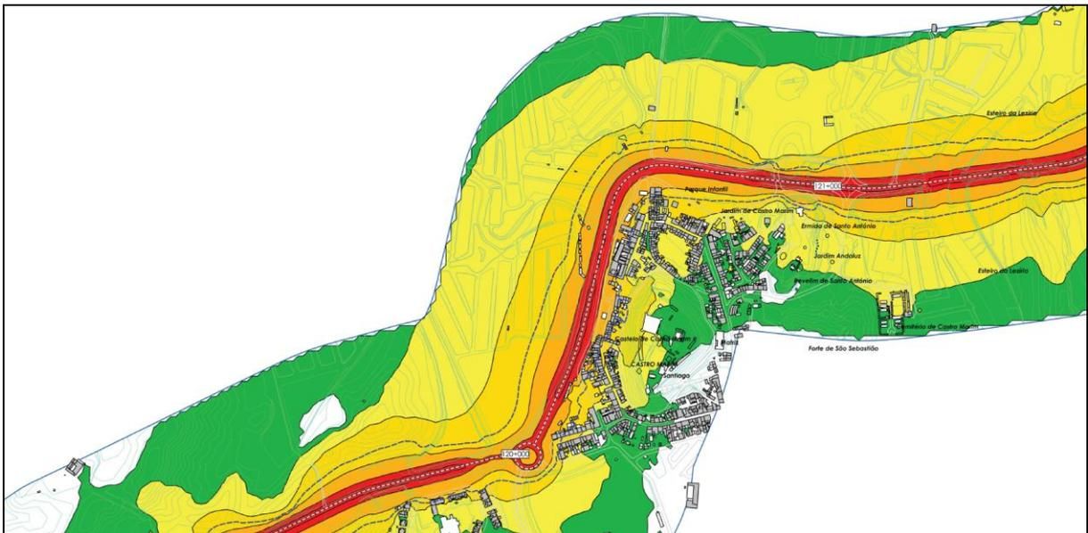
Figura 4-4 – Extrato do MER da EN122 para o indicador L<sub>n</sub>
