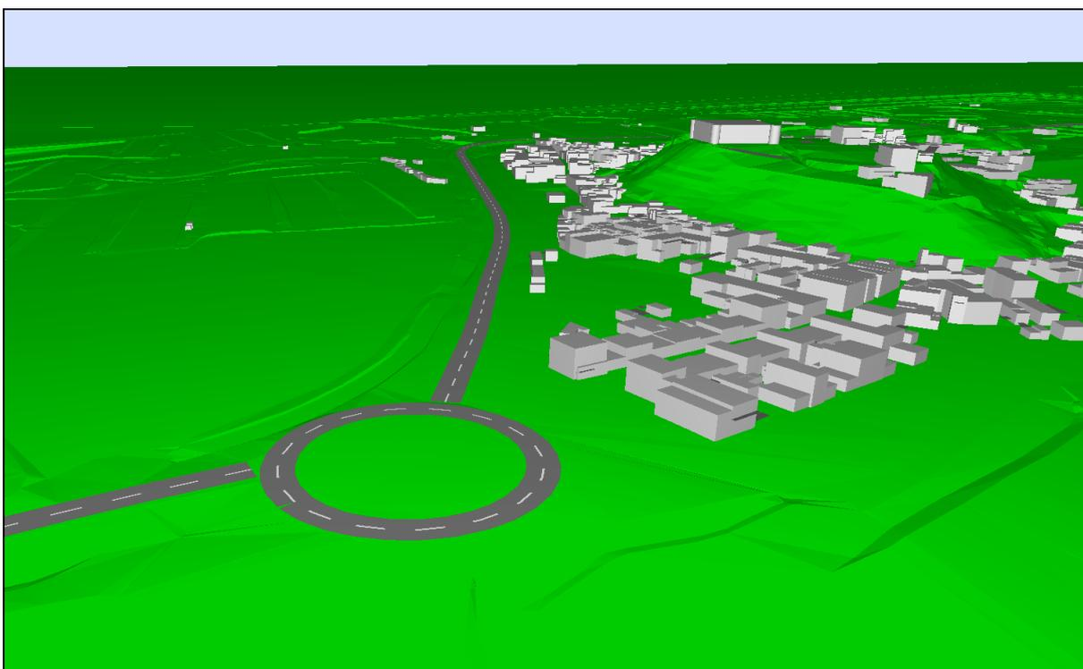
**Figura 4-1 – Modelo digital do terreno construído com base nos elementos cartográficos, já com o troço da EN122 implantado – zona de Castro Marim**
