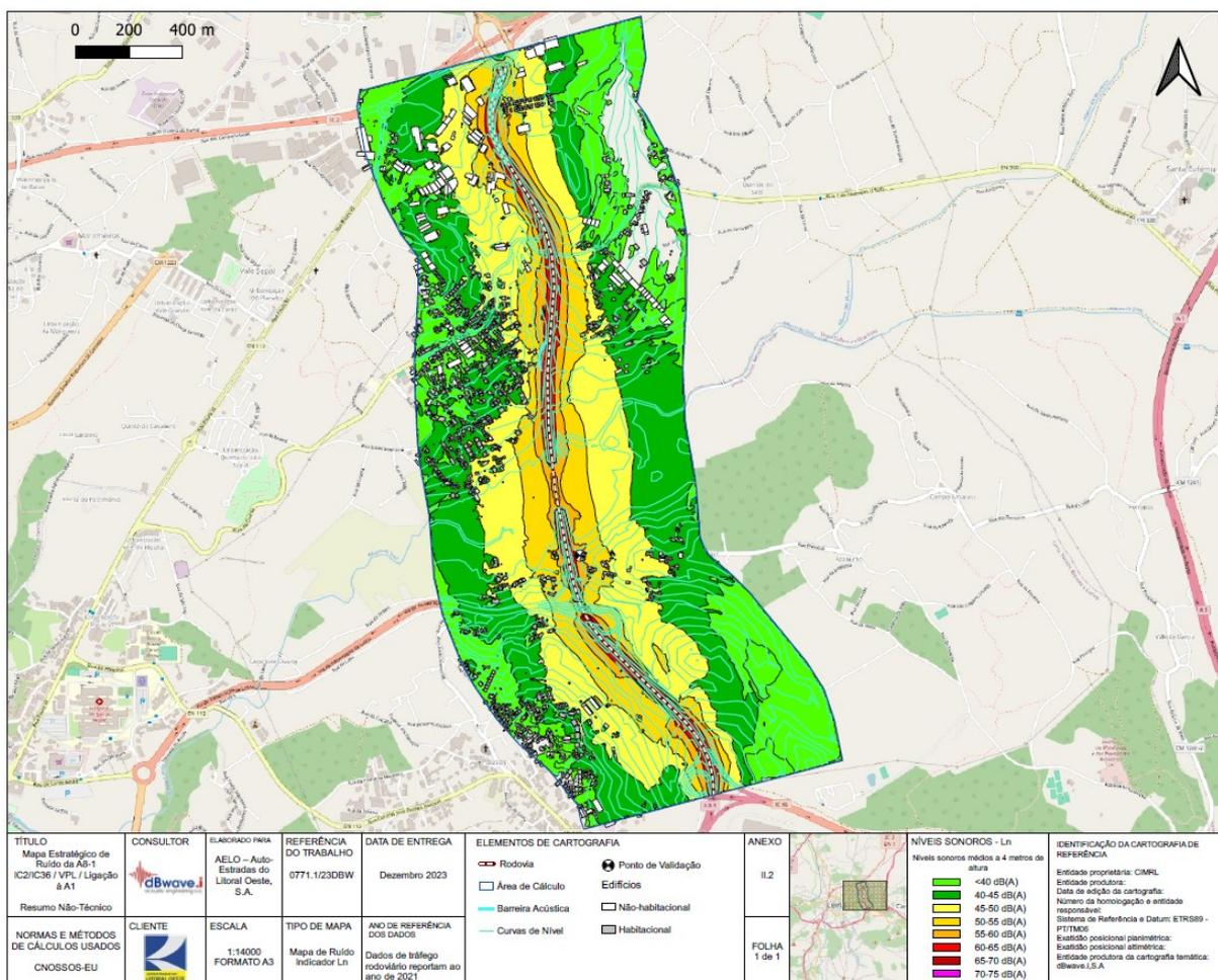
Figura 6 – Extrato do MER da A8-1 / COL - Circular Oriente de Leiria para o indicador Ln
