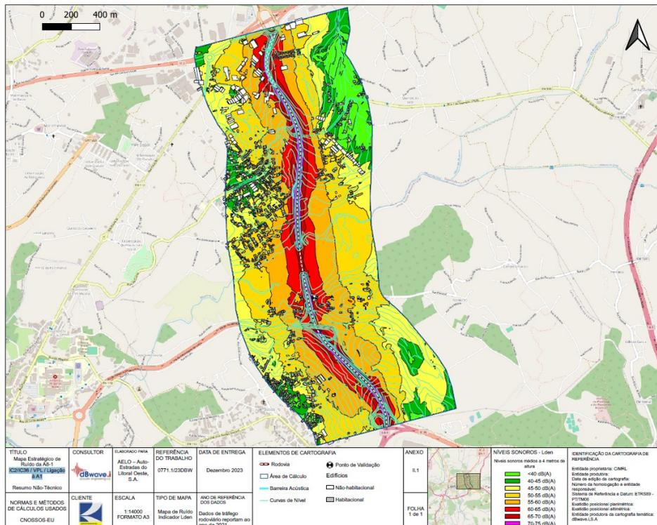
Figura 5 – Extrato do MER da A8-1 / COL - Circular Oriente de Leiria para o indicador L<sub>den</sub>
