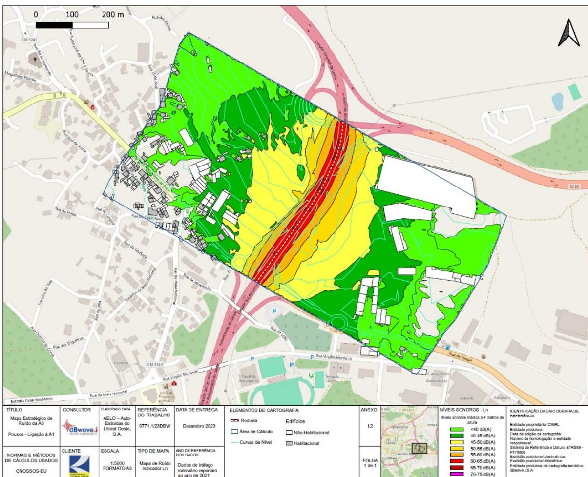
Figura 6-3 – Extrato do MER da A8 - (IC36) Leiria Sul (IC2) / Leiria Nascente para o indicador Ln.
