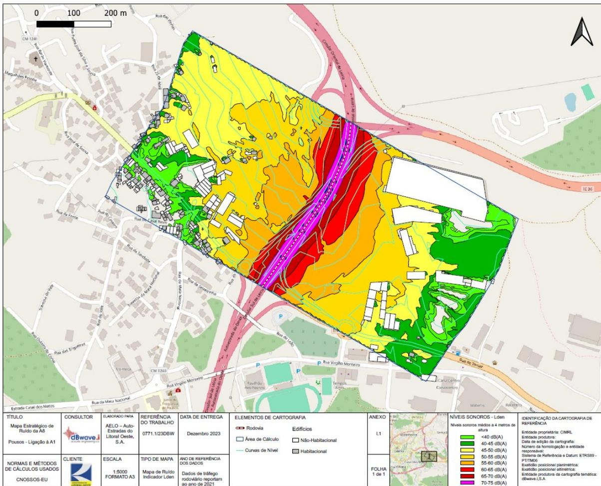
Figura 6-2 – Extrato do MER da A8 - (IC36) Leiria Sul (IC2) / Leiria Nascente para o indicador Lden.
