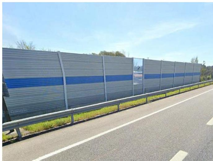
Figura 3: Barreira metálica com acrílico.
