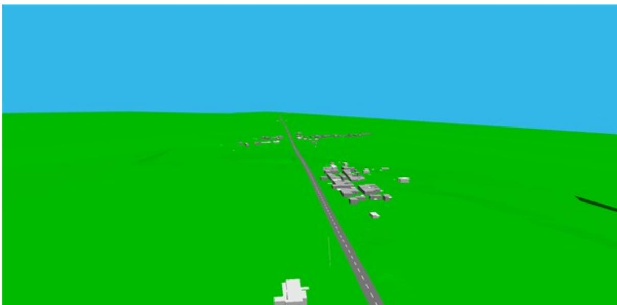
**Figura 3 – Modelo digital do terreno construído com base nos elementos cartográficos, já com o troço do IC1 implantado**
