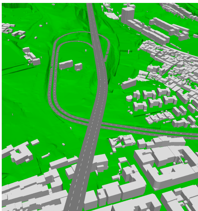
Figura 5 – Modelo digital do terreno construído com base nos elementos cartográficos, já com a ponte implantada - viaduto de acesso norte e o acesso de Alcântara.
