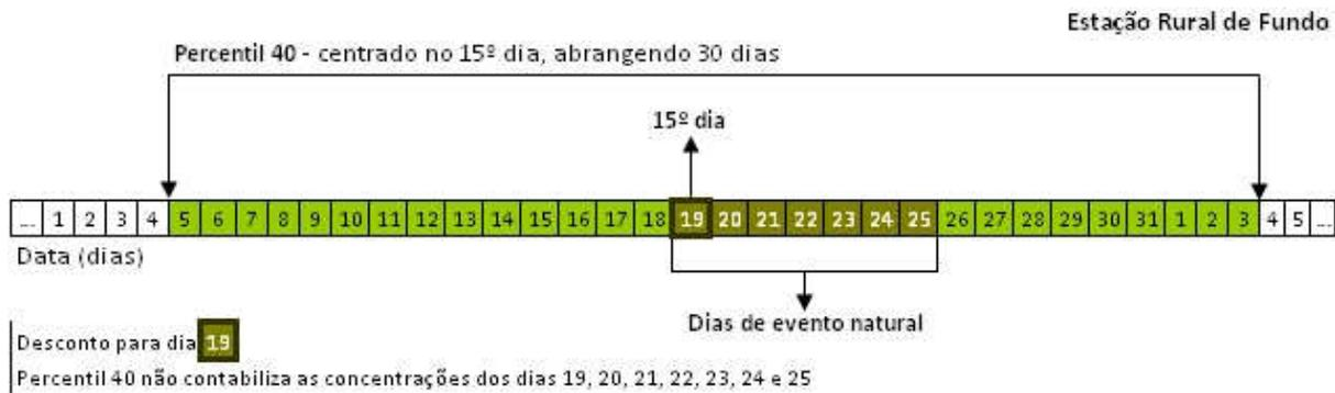
**Figura 4. Representação esquemática da metodologia de desconto (Caso 2)**
