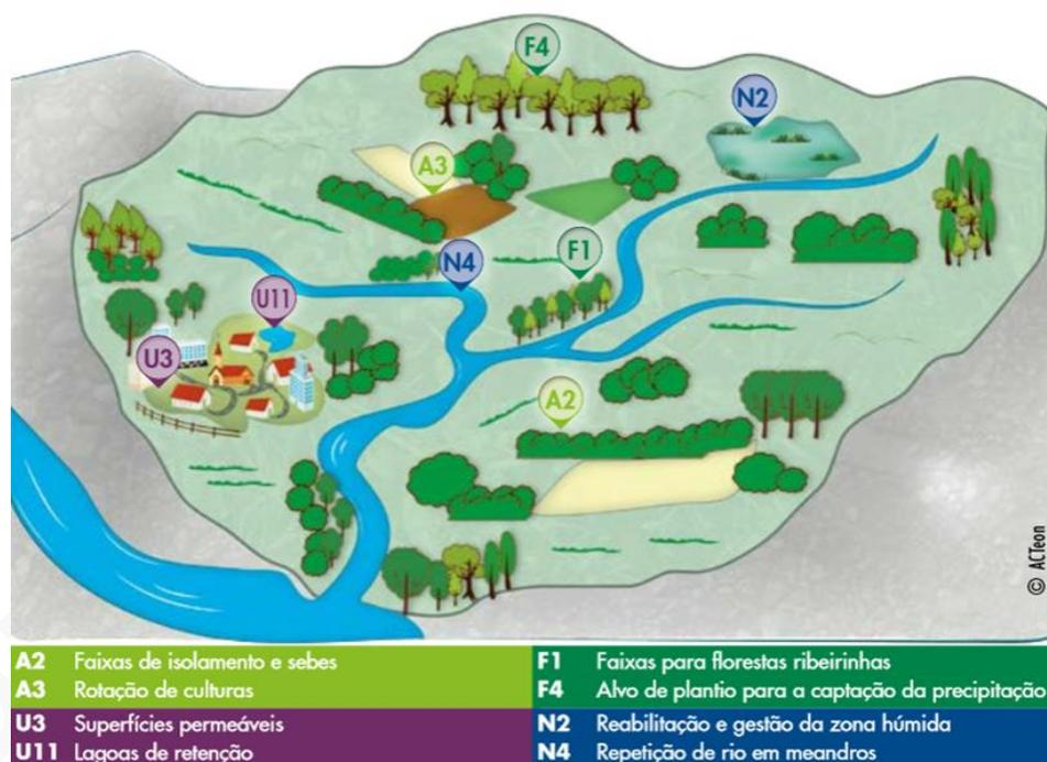
**Figura 25 - Representação esquemática de uma bacia hidrográfica e implementação de medidas verdes (NWRM, 2013)**
