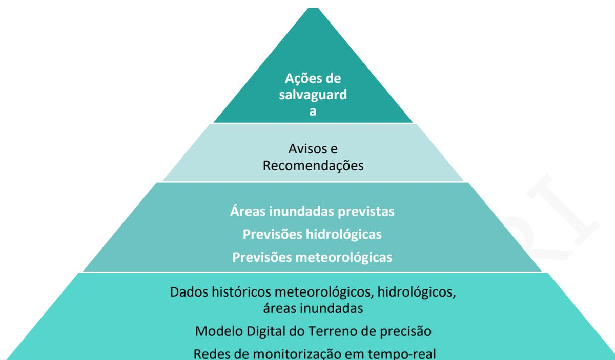
*Figura 22 - Componentes de um Sistema de alerta e previsão (Fonte: WMO Bulletin Volume 67 (1), 2018)*
