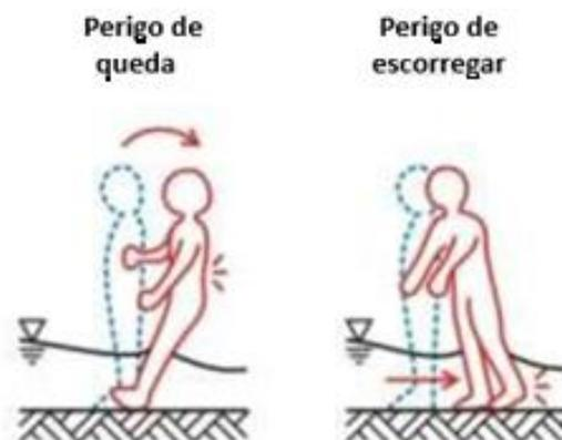
**Figura 53 – Instabilidade causada em pessoas em situação de inundação (Fonte: adaptado de Shand et Al., 2011)**
