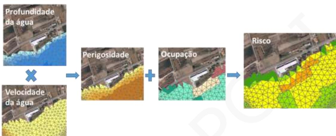
*Figura 65 - Cartografia para a determinação das cartas de risco no âmbito da Diretiva das Inundações*
