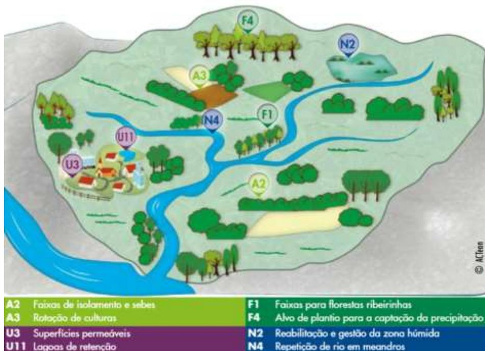
**Figura 44 - Representação esquemática de uma bacia hidrográfica e implementação de medidas verdes (NWRM, 2013)**
