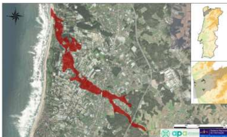
Figura 21 - Área inundada para o período de retorno de 100 anos, ARPSI de Póvoa de Varzim
