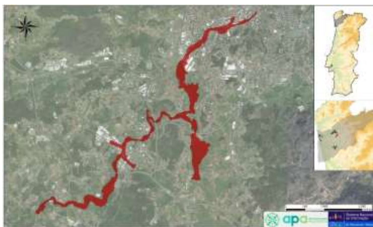
Figura 17 - Área inundada para o período de retorno de 100 anos, ARPSI de Braga - Este
