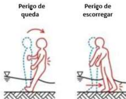
Figura 55 - Instabilidade causada em pessoas em situação de inundação (adaptado de Shand et al., 2011)
