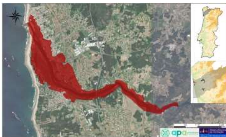
Figura 19 - Área inundada para o período de retorno de 100 anos, ARPSI de Esposende
