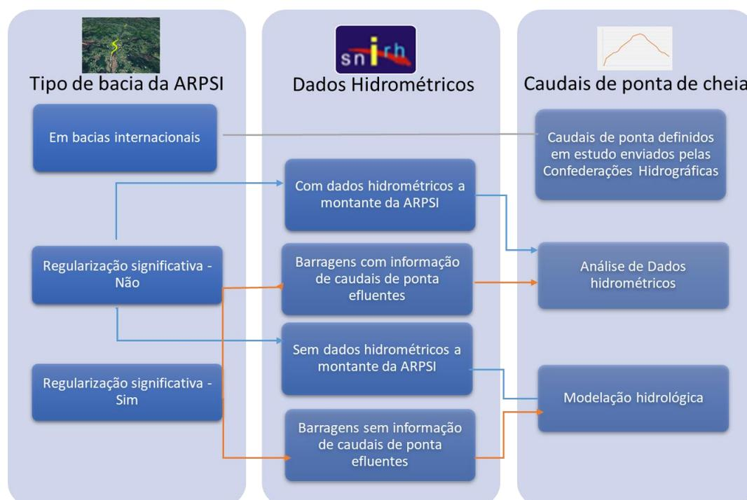
Figura 10. Esquema da modelação hidrológica (Aqualogus e Hidromod, 2020)
