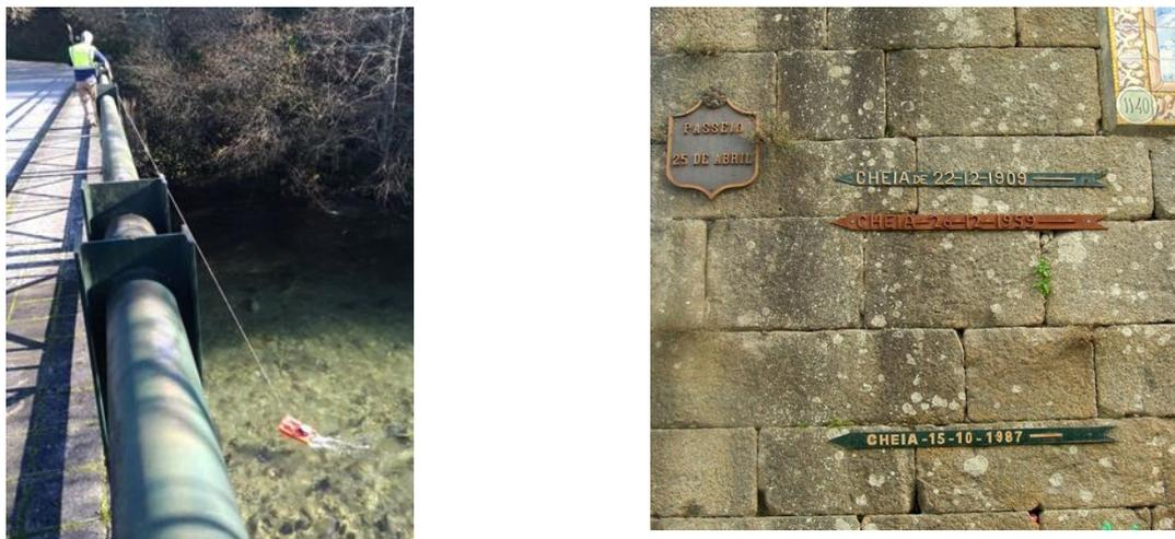
Figura 8. Elementos necessários à modelação hidrológica e hidráulica, medição de caudal e marcas de cheia
