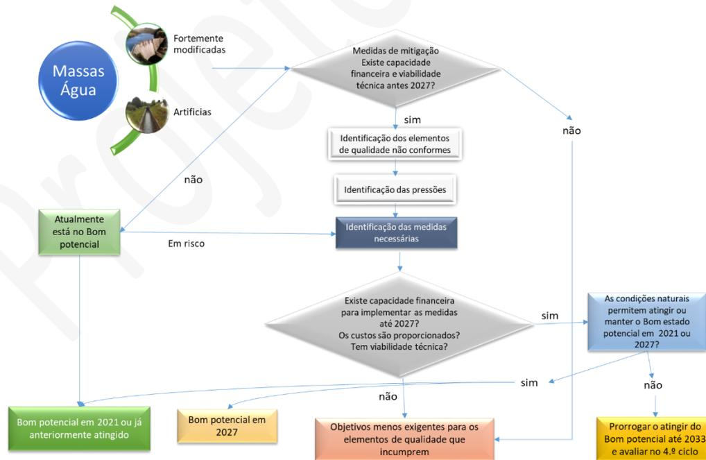
**Figura 3.4 – Esquema usado no estabelecimento de objetivos gerais de massas de água fortemente modificadas e artificiais**
