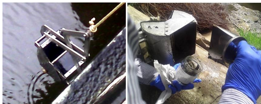
Figura 3.7 – Draga tipo “Petit Ponar”.
