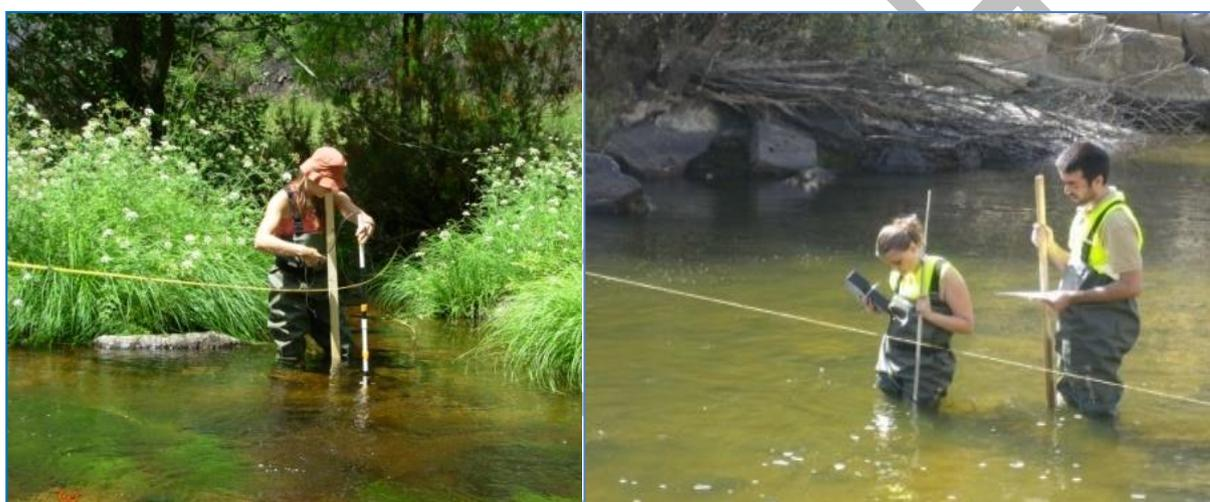
**Figura 3.32 - Procedimento de medição de caudal**
