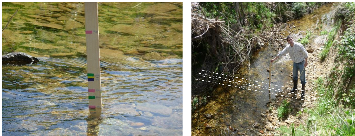
Figura 3.4 - Exemplo da visualização in situ dos níveis de escoamento para os RCE determinados por diferentes métodos no âmbito da metodologia holística desenvolvida em Portugal
