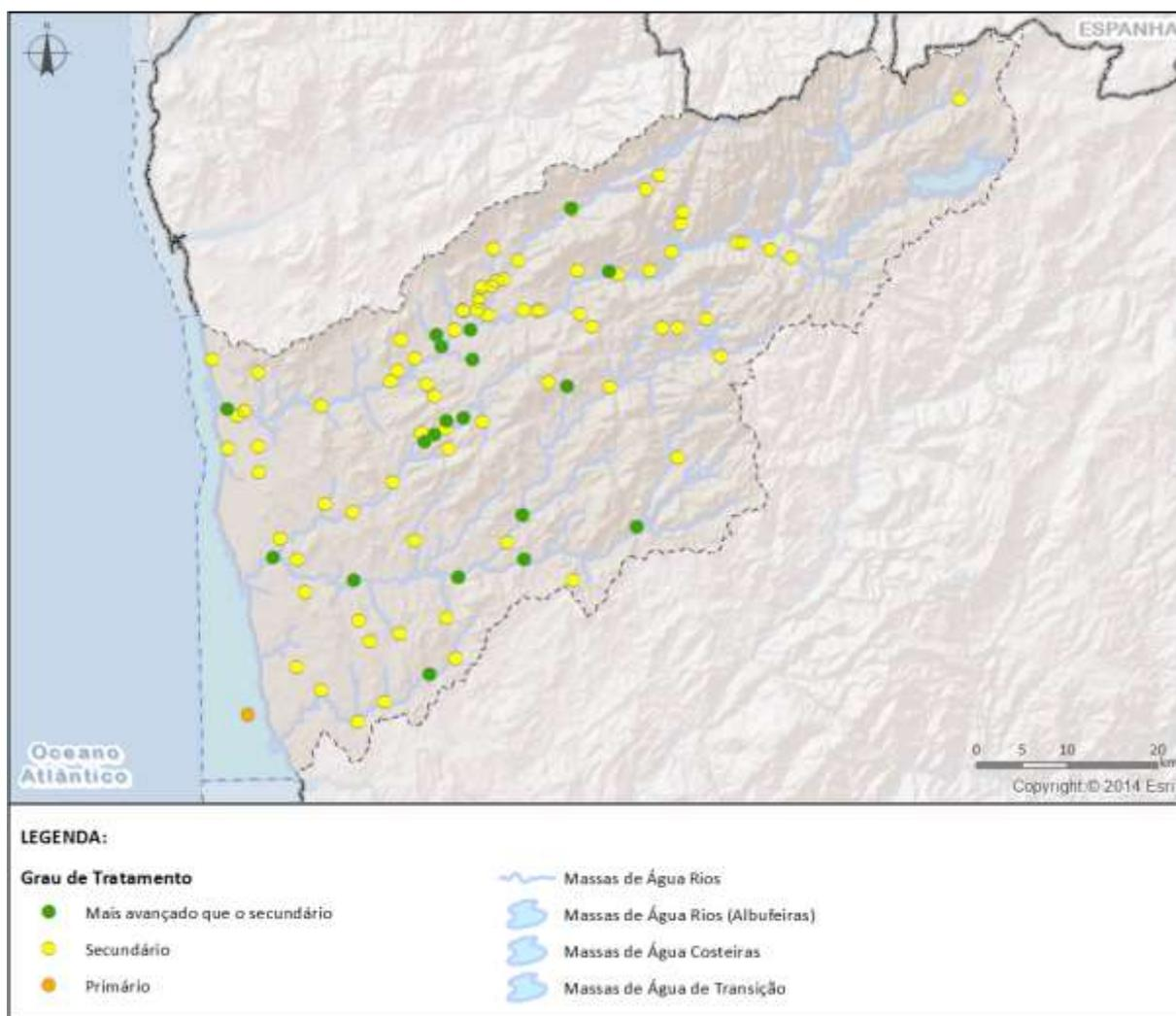
**Figura 2.2 - Pontos de descarga no meio hídrico das ETAR urbanas na RH2**
